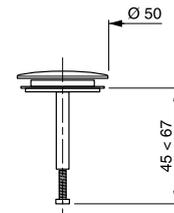
Clapet recouvrant pour vidage à câble
