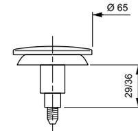
Clapet rentrant pour vidage à câble
