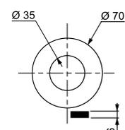
**M44 Joint de clapet 25 x 68 x 4**
