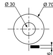
M41 Joint de clapet 35 x 65 x 5
