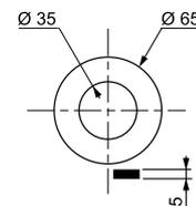
M42 Joint de clapet 35 x 70 x 6
