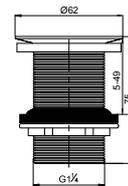
**BONDES à écoulement libre en laiton**
