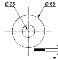
**M45 Joint de clapet 5 x 66 x 5**
