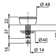
Corps et câble pour mécanisme double chasse WIRQUIN FLEXIFLOW
