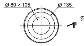
**BAGUE avec joint de sortie de cuvette**
