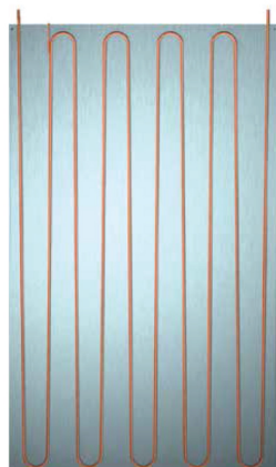
Méandre simple (EM) jusqu'à 3 capteurs dans la connexion en série, jusqu'à 5 avec un faible débit.
