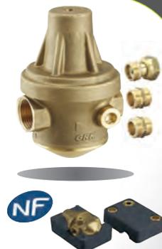
Réducteur de pression MAXIBAR à membrane DF avec 3 raccords multi-filetés. Corps laiton matricé avec siège en acier inoxydable, avec prise mano latérale et bouchon 1/4", grenailé.
