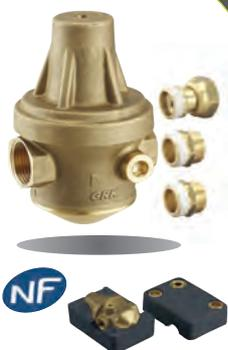
Réducteur de pression MAXIBAR à membrane DF avec trois raccords multi-filetés. Corps laiton matricé avec siège en acier inoxydable, avec prise mano latérale et bouchon 1/4", grenailé.
