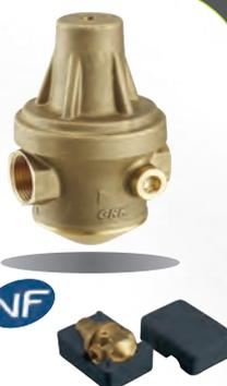
Réducteur de pression MAXIBAR à membrane DF. Corps laiton matricé avec siège en acier inoxydable, avec prise mano latérale et bouchon 1/4", grenailé.
