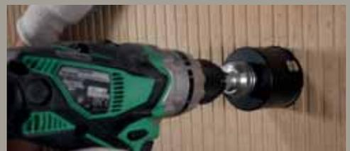
Permet d'utiliser 2 scies trépan en simultanées pour améliorer le centrage ou agrandir un trou existant.
