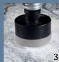
1. Réalisez un pré-trou avec le foret monté sur perceuse via le système onehand. 2. Puis montez en simultanément le foret et la scie trépan (enlevez au préalable le connecteur du foret) sur le pilote OneHand. 3. Percez en insérant le foret dans le pré-trou.
