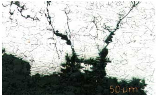
Exemple de fissure de contrainte transcrystalline liée à la corrosion sur de l'acier inoxydable 1.4401 avec une concentration en chlorure élevée.
